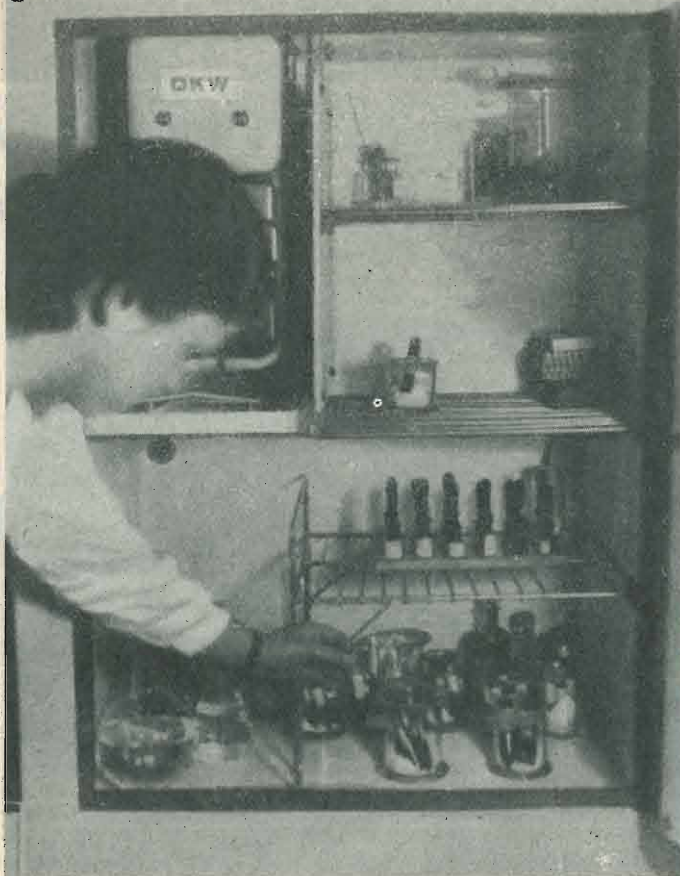
3. In attesa di essere esaminato il sangue viene conservato in piccoli provini che si tappano in alto, con del cotone. I provini vengono collocati in recipienti di vetro riposti in un refrigerante elettrico affinché il sangue mantenga la proprietà vitale.
