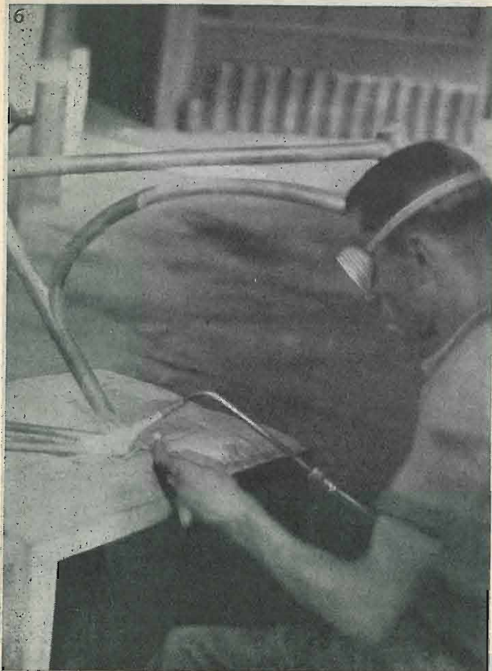
6. Si saldano gli attacchi dei freni e della pompa.
